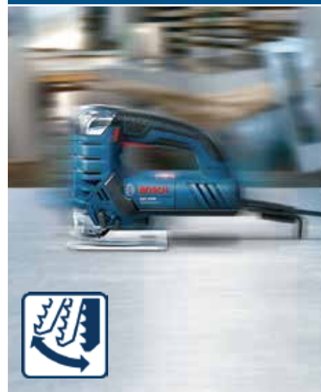
锯片摆动能提高切割速度(椭圆切割行程增加进刀量)，提高切割效率，但切口比较粗糙，适合粗切。
