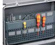
Fächerartige Werkzeugtableaus Fold-down (fanlike) tool panels
